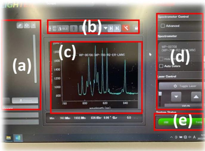
ENLIGHTEN™ 分光法ソフトウェアは分光分析に必要な露光時間、積算回数、レーザー強度の設定など最小限度の機能を搭載し、操作は簡単です。Wasatch Photonicsから発売されているすべての励起波長の分光器に本ソフトウェアは対応しています。
