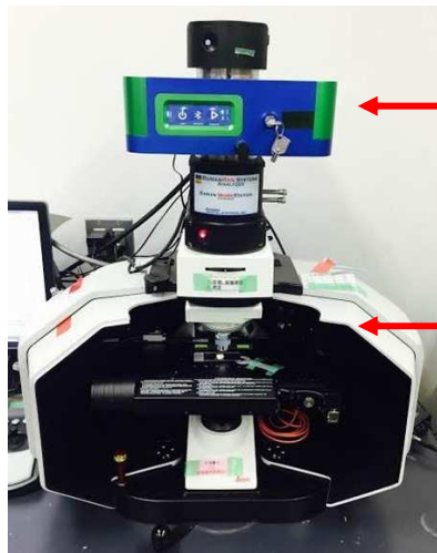
低波数モジュールを搭載した ラマン顕微鏡 (TR-Micro WorkStation)
